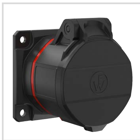
CEE NEO Anbaudose gerade 5 x 16 A | 6h | IP54 mit Schraubanschluss oder Käfigzugfeder
