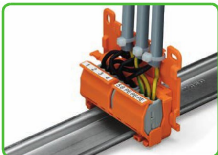
Senkrechte Montage mit Zugentlastungsplatte auf TS 35. Klemmstellen-Kennzeichnung durch Bezeichnungstreifen
