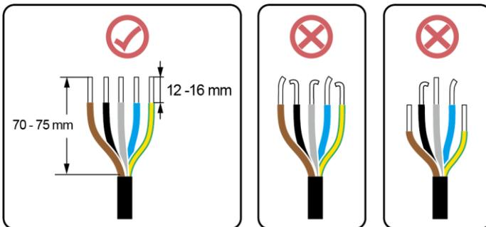
1. Schließen Sie das AC-Ausgangsstromkabel an den AC-Steckverbinder an.
