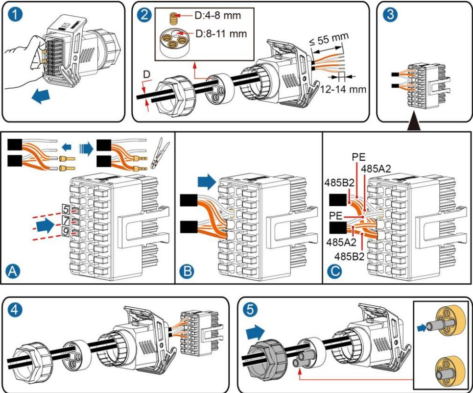
2. Verbinden Sie den Signalkabelverbinder mit dem Kommunikationsport.
