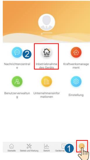
2. Stellen Sie eine Verbindung zum WLAN des Wechselrichters her. Melden Sie sich als **installer** an und führen Sie **Schnelleinstellungen** aus.
