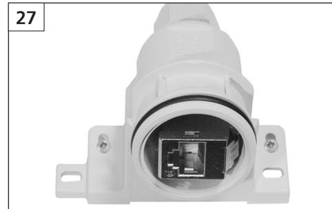
Beim Anschließen eines IP67 Steckers die Seitenflügel leicht zusammendrücken und den Stecker auf die Anschlussdose rasten.
