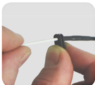
Abb.: Klemmgummi anbringen
