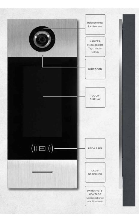
VILLA VIDEO Freisprechanlage mit integriertem 7" Touchscreen-Farbmonitor für 1 bis 8 Familien, inklusive UP-Gehäuse und einer RFID-Transponder-Karte (Admin-Karte).
