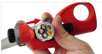
Für Längsschnitt Stellung auf das Symbol Längsschnitt (→) umstellen und Gerät axial in Längsrichtung ziehen
