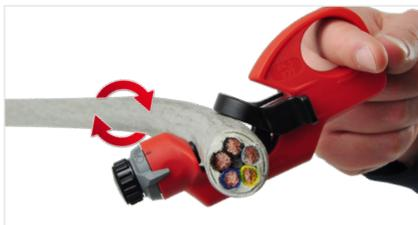
Gerät auf die Markierung der Abisolierlänge aufsetzen und den Rundschnitt durchführen
