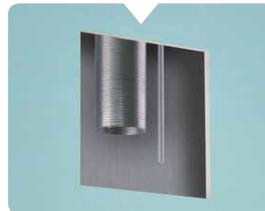
**2** Zur Vorbereitung der Montage wird der entsprechende Vorwandausschnitt erstellt.
