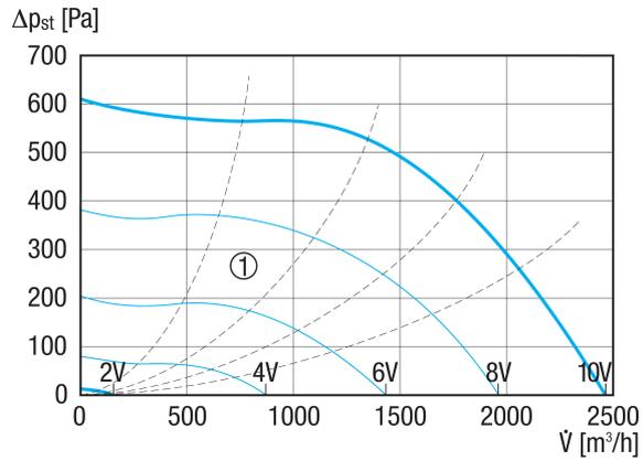
① Hilfskennlinien zu Steuerspannung 2 - 10 V
