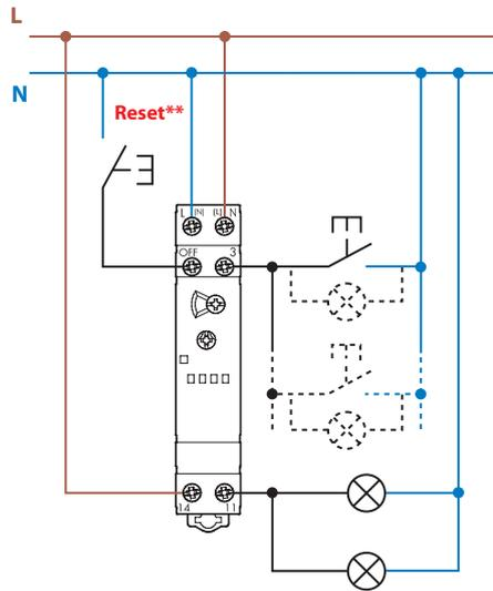
\*\* Über den Reset-Taster ist eine "Zentral AUS"-Funktion mit Tastendruck > 3 s realisierbar.
