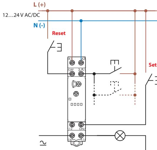
**Typ 13.61.8.230 - Beispiel für die Parallelschaltung von 13.61.8.230 mit "Zentral AUS" - Taster im 4-Leiteranschluss - Betrieb**
