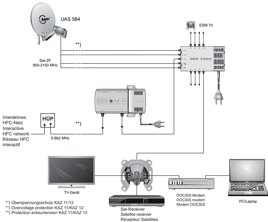
**Hinweis:** Der Multischalter und die Sat-Hausverteilanlage müssen für die Übertragung von DOCSIS-Signalen ausgelegt sein (Rückweg: 5-65 MHz, Vorförtsweg: 85-862 MHz). Multischalter der Serie EXR 15xx sind auf Grund des integrierten terrestrischen Verstärkers für die DOCSIS-Übertragung nicht geeignet.
