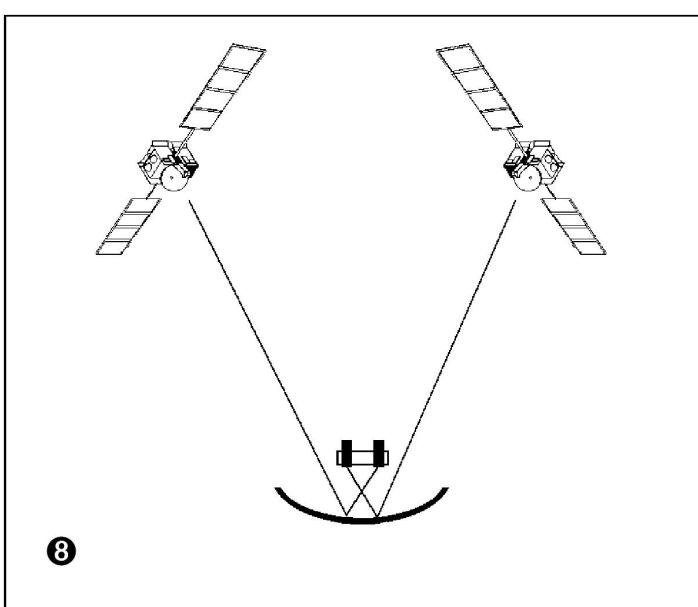
**Tip:** Bei Multifeedanwendungen sollte die Antenne auf den Satelliten ausgerichtet werden, der die pegelschwächeren Signale sendet.
