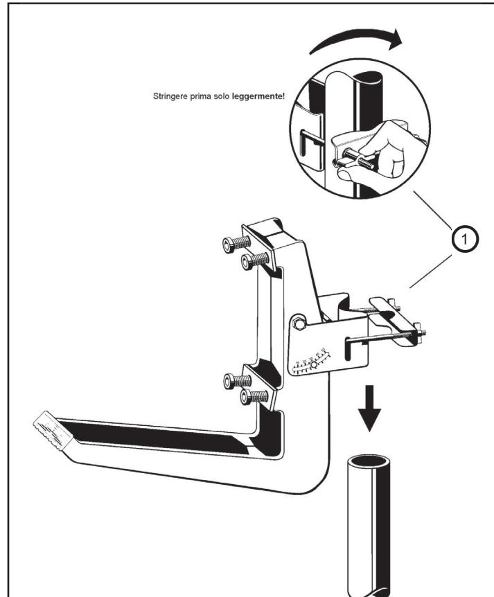
② Fissare successivamente il riflettore nelle viti di fissaggio premontate.
