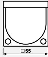
**IP** Mit Dichtungsset Art.-Nr.: AS A 50 DS und programmspezifischen "IP-44-Rahmen" ist der Schutzgrad IP 44 gewährleistet.
