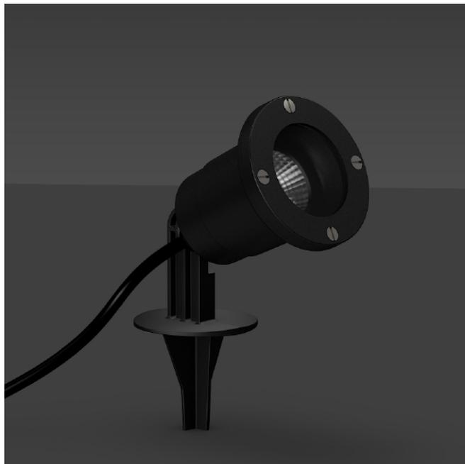
Kompakter Außenstrahler für PAR16 Netzspannungs-Reflektorlampen mit Erdspeiß. Gehäuse Aluminium-Druckguss pulverbeschichtet. Sicherheitsglas klar. Erdspeiß aus faserverstärktem Kunststoff. Mit Anschlussleitung 3 m inklusive Schukostecker.
