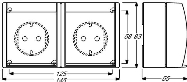
ocean® 2-fach waagrecht SCHUKO® Steckdosen mit Bohrmaßen
