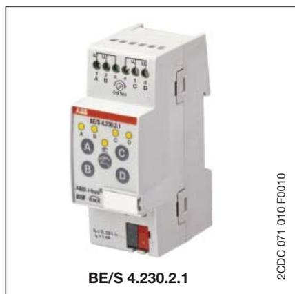
Der 4fach Binäreingang BE/S 4.230.2.1 mit manueller Bedienung ist ein Reiheneinbaugerät zum Einbau in den Verteiler. Das Gerät ist zum Erfassen von 10...230-V-AC/DC-Signalen geeignet. Die Eingänge A und B sind von den Eingängen C und D unabhängig.
