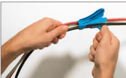
Kabelbündel seitlich in das Aufziehwerkzeug legen.
