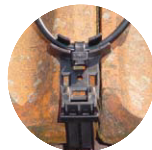
Die DEVIdclip™ Schutzgitterhaken (Best. Nr. 19-805193) ermöglichen eine "Zick-Zack" Montage der Heizleitung
