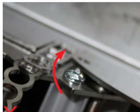
✗ Falsch / Wrong / Faux Lasche behindert die Schraube. Schraube kann nicht wegtauchen. / Metal strap not bent back inhibits the screw movement. / La patte n'est pas repliée et gêne le mouvement de la vis.
