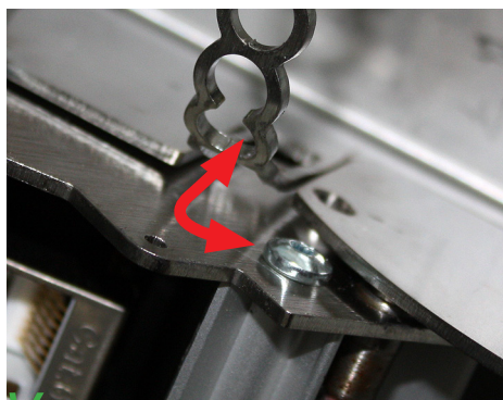
✓ Richtig / Right / Correct Schraube kann unter der Lasche wegtauchen. / Please ensure the metal strap is bent back, allowing the screw to move properly. / Vous assurer que la patte soit repliée, permettant à la vis de se déplacer correctement.
