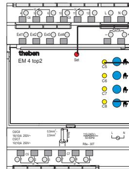
rote LED Set blinkt: eine Jahresschaltuhr TR top2 schickt Anfrage „Modul EM 4 zuweisen“ (einlernen)
