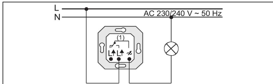
Der Anschluss des Drehdimmers für Glühlampen (1) erfolgt über Schraubklemmen.
