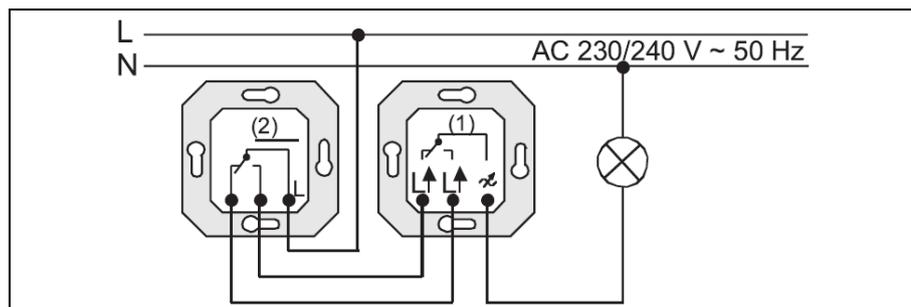
Mit dem mechanischen Wechselschalter (2) wird die Last ein-/ ausgeschaltet. Die Helligkeitseinstellung erfolgt ausschließlich über den Drehdimmer für Glühlampen (1).
