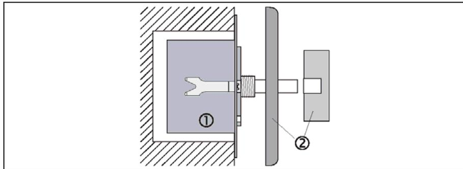
Der Drehdimmer für Glühlampen (1) wird in einer Gerätedose nach DIN 49073 montiert.
